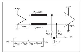
FIGURE 5A. LVPECL OUTPUT TERMINATION
