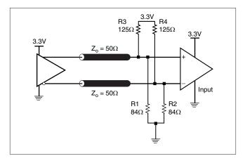
FIGURE 5B. LVPECL OUTPUT TERMINATION
