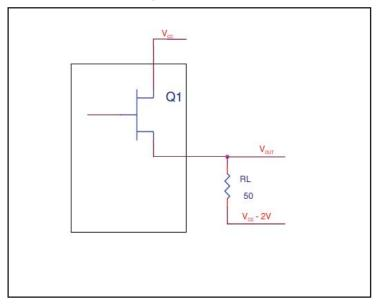
FIGURE 7. LVPECL DRIVER CIRCUIT AND TERMINATION
